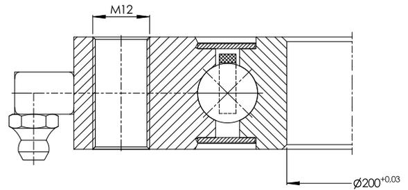
3 Kegelschmiernippel, DIN 71412- C M8x1, gleichmäßig am Umfang verteilt
